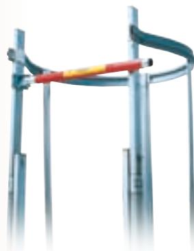
Gemäß GUV 7.4 § 5 Abs. 9 müssen Steigleitern mit mehr als 5 m Absturzhöhe „mit baulichen Einrichtungen zum Schutz gegen Absturz von Personen ausgerüstet sein. Diese Forderung ist erfüllt, wenn ... ein Steigschutz fest angebracht ist, eine Seilsicherung mit festem Anschlagpunkt und Sicherheitsgurt nach den ‚Richtlinien für Sicherheits- und Rettungsgeschirre‘ (GUV 10.4) verwendet wird“.
