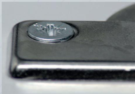
Der Kombikopf passt genau in eine 90°-Senkung. Dank der hinterschnittenen Frästaschen reibt die Fräskante nicht an der Beschlagoberfläche, die Schraube liegt flächig im Beschlag an. Dadurch wird die Beschlagoberfläche beim Einschrauben nicht beschädigt.
