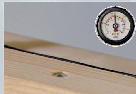
Bei der Montage dickerer Anbauteile führt die Fixierung mittels Gewinde zu einer deutlich höheren Belastbarkeit der Verbindung. Das spart Montagepunkte und/oder führt zu höherer Sicherheit.
